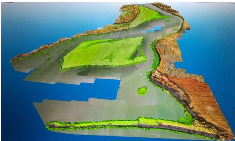
Figura 11. Restituzione rilievo con Drone da software di fotogrammetria.
